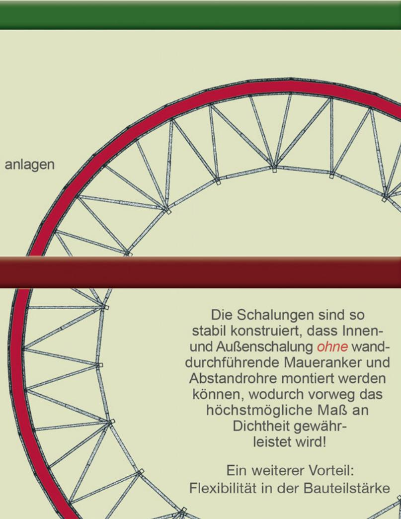
Die Schalungen sind so stabil konstruiert, dass Innen- und Außenschalung *ohne* wanddurchführende Maueranker und Abstandrohre montiert werden können, wodurch vorweg das höchstmögliche Maß an Dichtheit gewährleistet wird!
